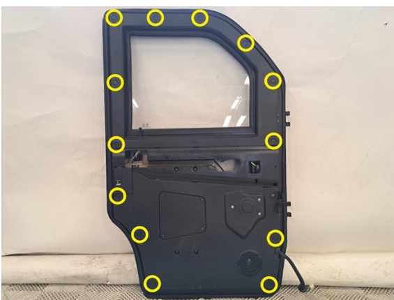
Irrota kiinnitysruuvien suojakorkit. (pieni talttameisseli).
