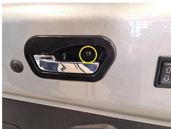
Irrota oven sisäpuolen avauskahvan kiinnitysruuvit. (ristipäämeisseli ph2).
