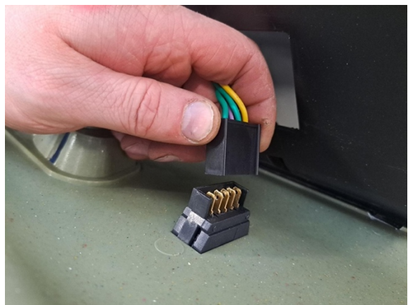
Irrota lasin nostinkytkimen liitin.
