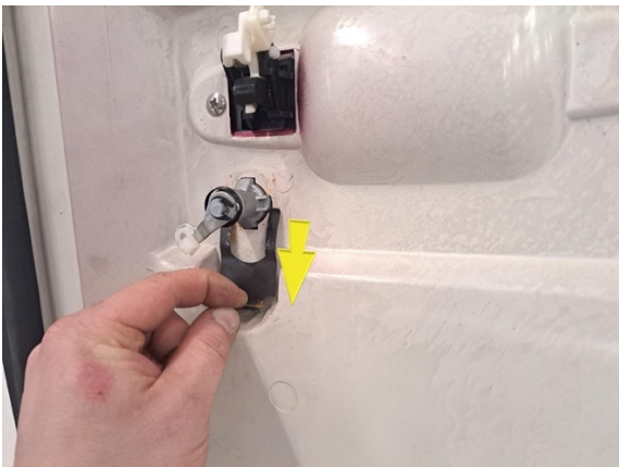
Irrota oven lukkopesän kiinnitysklipsi.
