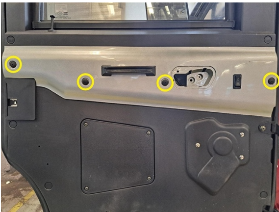
Irrota oven paneelin kiinnitysklipsut.
